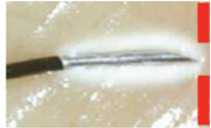
Posizionamento “assiale”: la superficie di contatto è ridotta.
